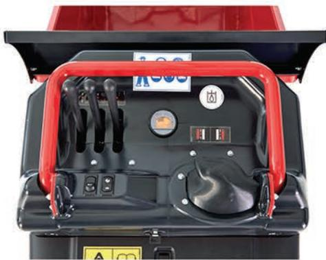
Pannello di controllo ancora più semplice e sicuro da utilizzare, grazie ai joystick ergonomici e al pulsante "enable" utile a evitare che l'operatore esegua movimenti in maniera accidentale e la possibilità di scegliere tra due velocità: "ecomode" sulle superfici sconnesse e per risparmio energetico, "power" su terreni piani.
